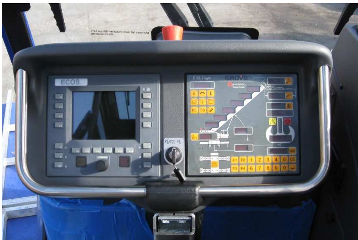
Přístrojový panel v kabině jeřábníka s displeji systémů ECOS a EKS 5 Light
