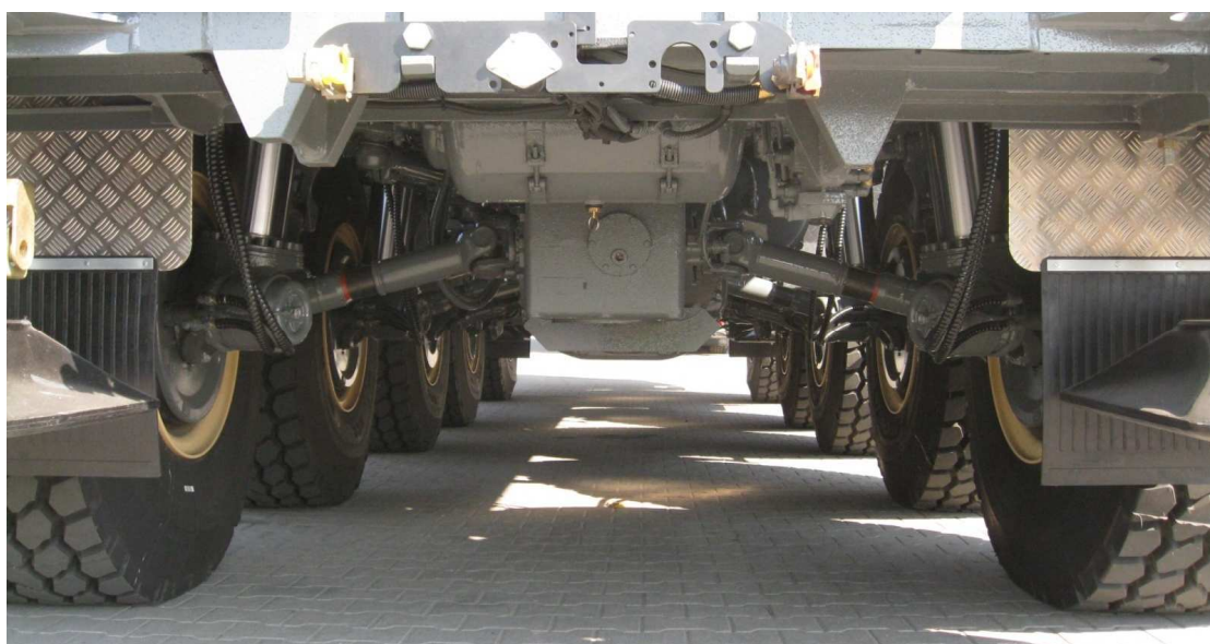
Podvozek MEGATRAK™. Vidět je diferenciál uchycený na spodní části skříňe podvozku a kardany pohonu kol.
